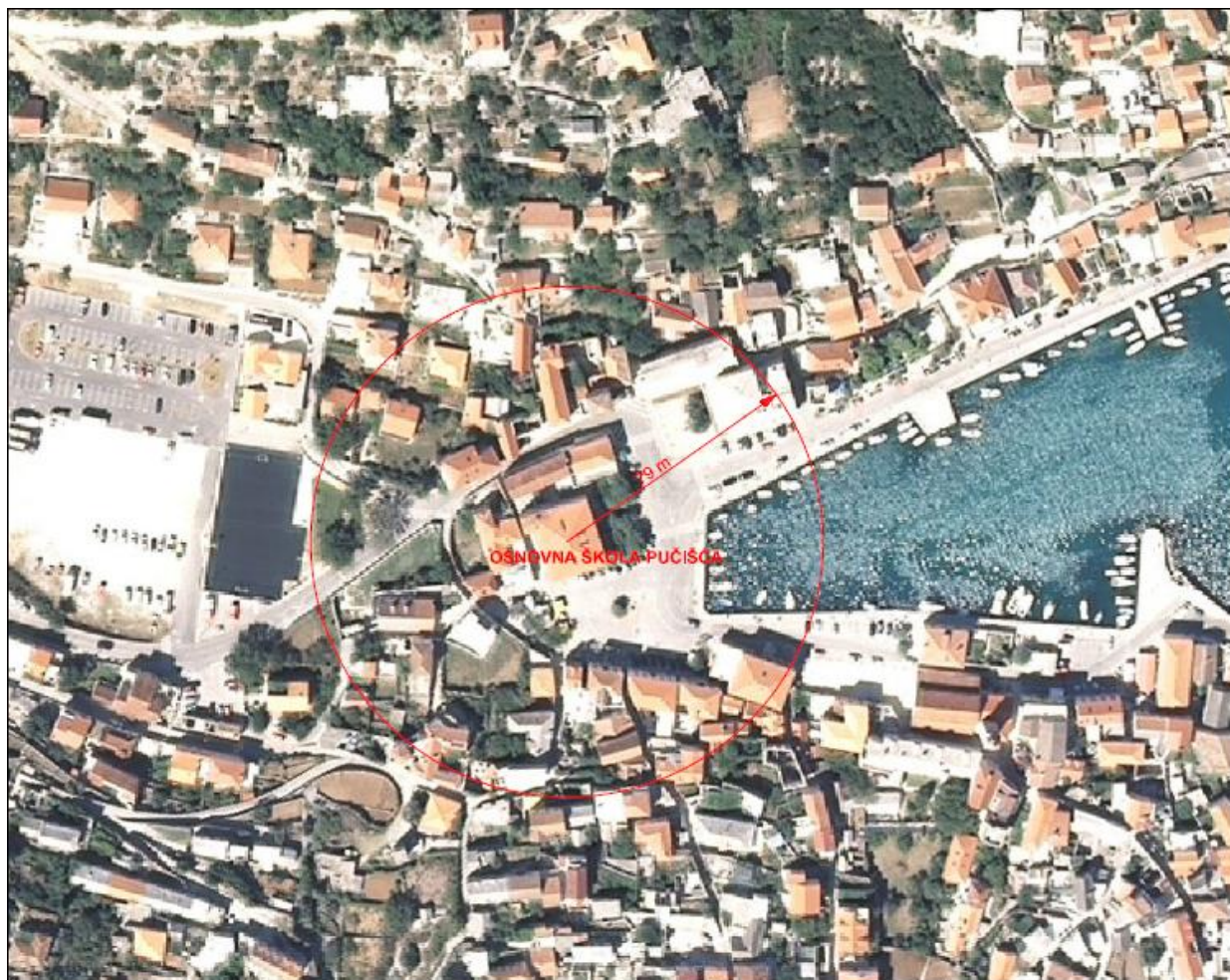
Slika 11. Veličina zone ugroženosti i maksimalni doseg učinka nesreće zapaljenja lokve lož ulja na lokaciji Centralne osnovne škole Pučišća
